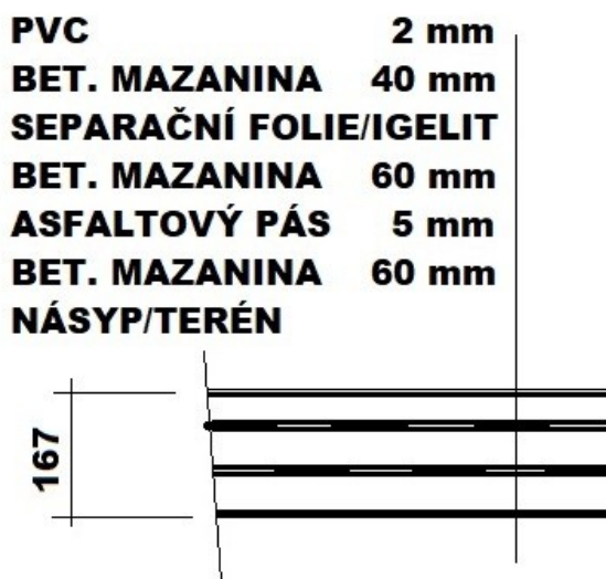
Obr. 11 Skladba v sondě S2
