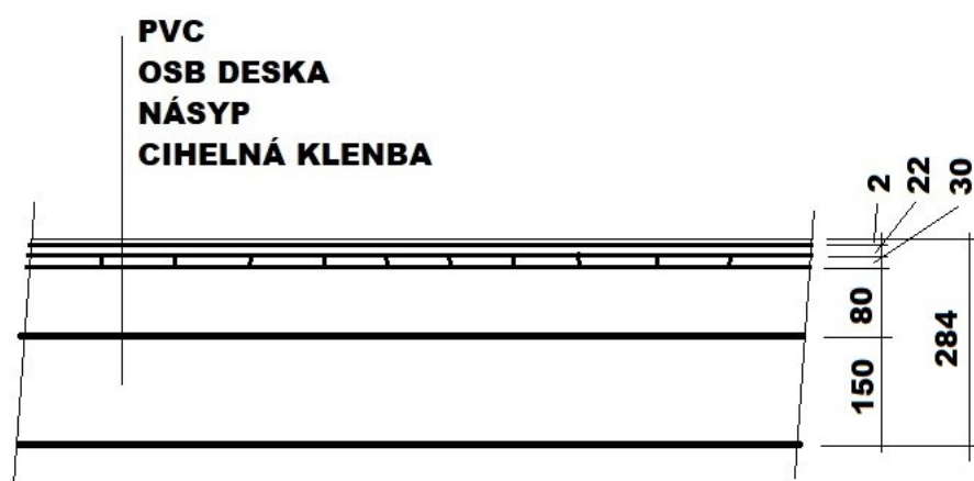
Obr. 15 Skladba v sondě S5
